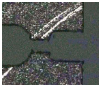
FIG. 4.12 – Organe terminal réalisé par usinage laser.
