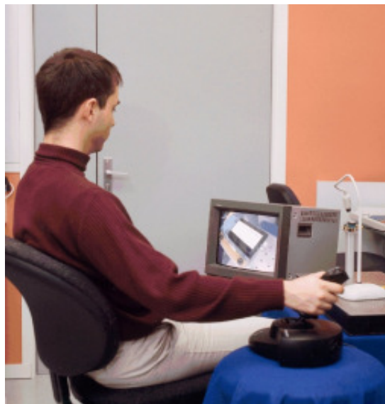
FIG. 4.28 – Micropinse MMOC télé-opérée au moyen d'une manette
