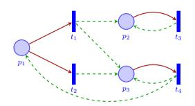
$$M \rightarrow_{t_1} \rightarrow_{t_2} \rightarrow_{t_1} \rightarrow_{t_2} \rightarrow_{t_3} M'$$
