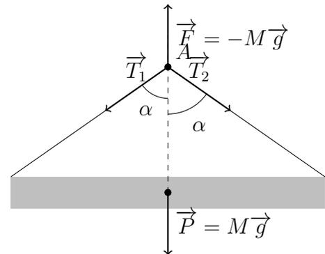
1. Sur la figure, on considère que l'axe des abscisses est l'axe horizontal passant par  $A$  et que l'axe des ordonnées est l'axe vertical passant par  $A$ . Projeter la somme des efforts appliqués au point  $A$  sur l'axe des abscisses, puis sur l'axe des ordonnées.
