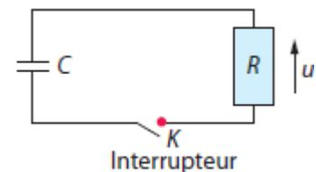
2. Déterminer à partir de quel instant  $t_1$  la tension  $u(t)$  vérifiera  $u(t) \leq \frac{1}{10}u_0$ .
