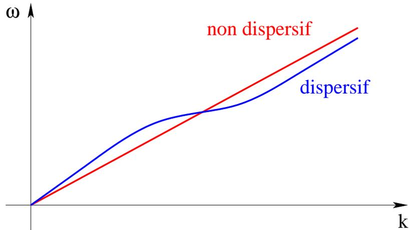
Pour un **paquet d'ondes** :  $u(t, x) = \frac{1}{2\pi} \int_{-\infty}^{\infty} \tilde{F}(\omega) \exp(i(\omega t - k(\omega) x)) d\omega$
