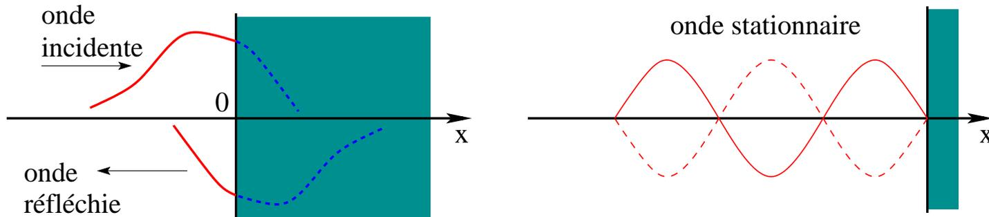
Soit l'onde plane incidente  $F_i(t - x/c)$ , l'onde réfléchie  $G_r(t + x/c)$  est aussi plane. L'onde totale est  $u(t, \mathbf{r}) = F_i(t - x/c) + G_r(t + x/c)$ .
