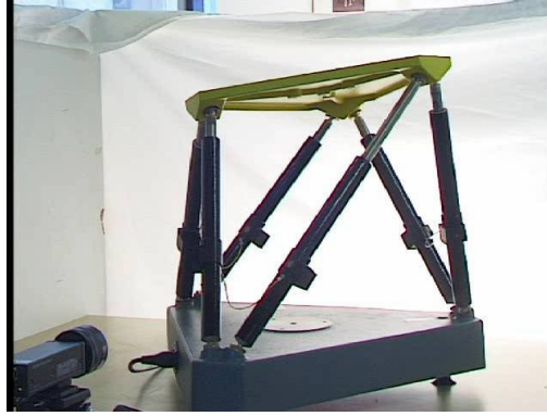
FIG. 3.11 – Dispositif expérimental pour l’asservissement visuel des jambes d’une plateforme de Gough-Stewart
